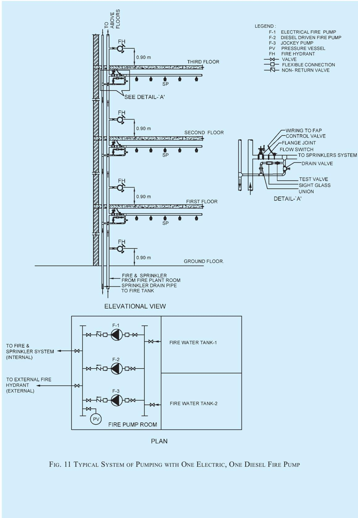
FIG. 11 TYPICAL SYSTEM OF PUMPING WITH ONE ELECTRIC, ONE DIESEL FIRE PUMP
